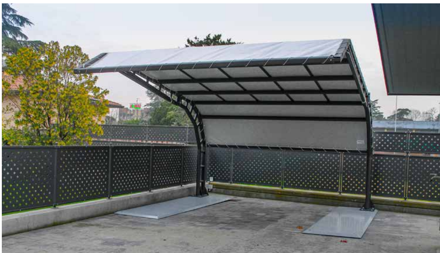
Pergolato Ibis, profondità 5m, passo 4m, composto da 1 modulo, con copertura telo in pvc. Trattamento superficiale di zincatura a caldo e verniciatura colore antracite. Fissaggio su piastroni da ~ 900 kg cad.
